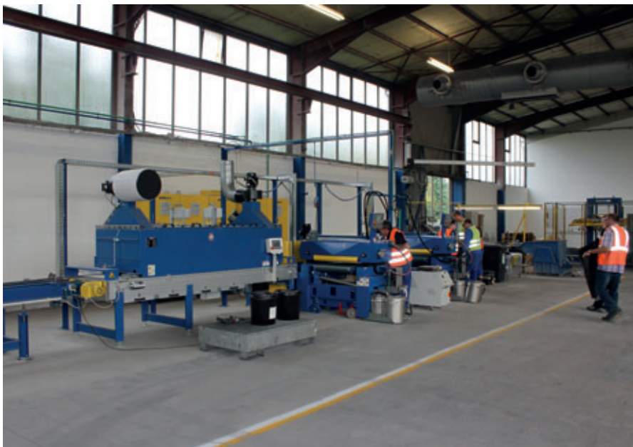
Aufbau und Einstellung der UV-Lack-Auftragswalze und des UV-Trockners bei der Firma Kann GmbH & Co. KG
